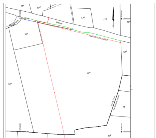
Kort med nedgravet 10 kV højspændingskabel
